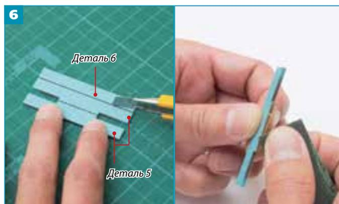
**6** Канцелярским ножом разделите подступенки (детали 5 и 6). Ровно разрежьте их по линии ножом (фото слева). Неровности от среза обработайте наждачной бумагой (фото справа).
